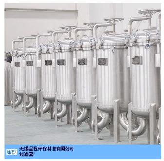
PY-SGD-IN系列袋式过滤器侧面进口,液体再从顶部进入滤器的设计,过滤器内未被过滤的液体减至\*\*少,更换滤袋非常方便,同时提供了较好的密封作用。 优势通过顶部进入和顶盖结构 顶盖\*\*\*压紧密封旋转式环首螺栓电解抛处理的冲孔滤篮可调整高度的脚架令更换滤袋 非常容易和快捷全无旁漏的密封易用及牢固的快关装置质量的滤袋承托,并且容易清洗稳定又可调的结构 技术参数参考HG21637-91□GB150-2011设计、制造、验收 法兰标准□HG GB SH HGJ JB ANSI JIS.接口形式:螺纹、卡箍、法兰 口径规格:1-1/2".排污口规格:1/4".滤袋型号:1# 2#,3#,4#.过滤精度□0.5um-800um.设计压力□1.6Mpa./设计温度:120℃.表面处理:玻璃珠喷砂;抛光;卫生级抛光 材料壳体材料□20#□304□316L□2205□2507.密封垫片:硅胶、丁晴橡胶、四氟橡胶滤袋材质:聚酯、聚丙烯、尼龙、聚四氟乙烯、玻纤
